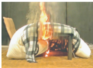
座いすとともに押し込められたこたつ布団から出火(NITEの再現実験)。
