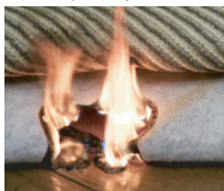
折り畳んでいた部分から出火(NITEの再現実験)。
